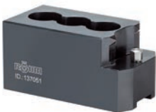
C 21 Krallenbacken, 1 Stück, gehärtet, Spitzverzahnung 60° - Nutbreite 12
