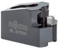
C 21 Krallenbacken, 1 Stück, gehärtet, Spitzverzahnung 90° - Nutbreite 17
