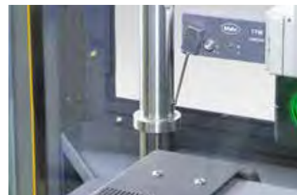
Taktile Messungen mit T7W
