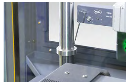
Taktile Messungen mit T7W
