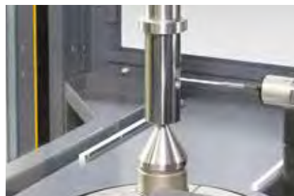
Taktile Messungen mit SP25
