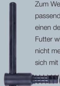
Zum Wechseln der Backen gibt es die passenden Futterschlüssel, sie werden in einen der drei Triebe gesteckt und das Futter wird soweit geöffnet, bis die Backen nicht mehr in den Spiralring eingreifen und sich mit der Hand herausziehen lassen.
